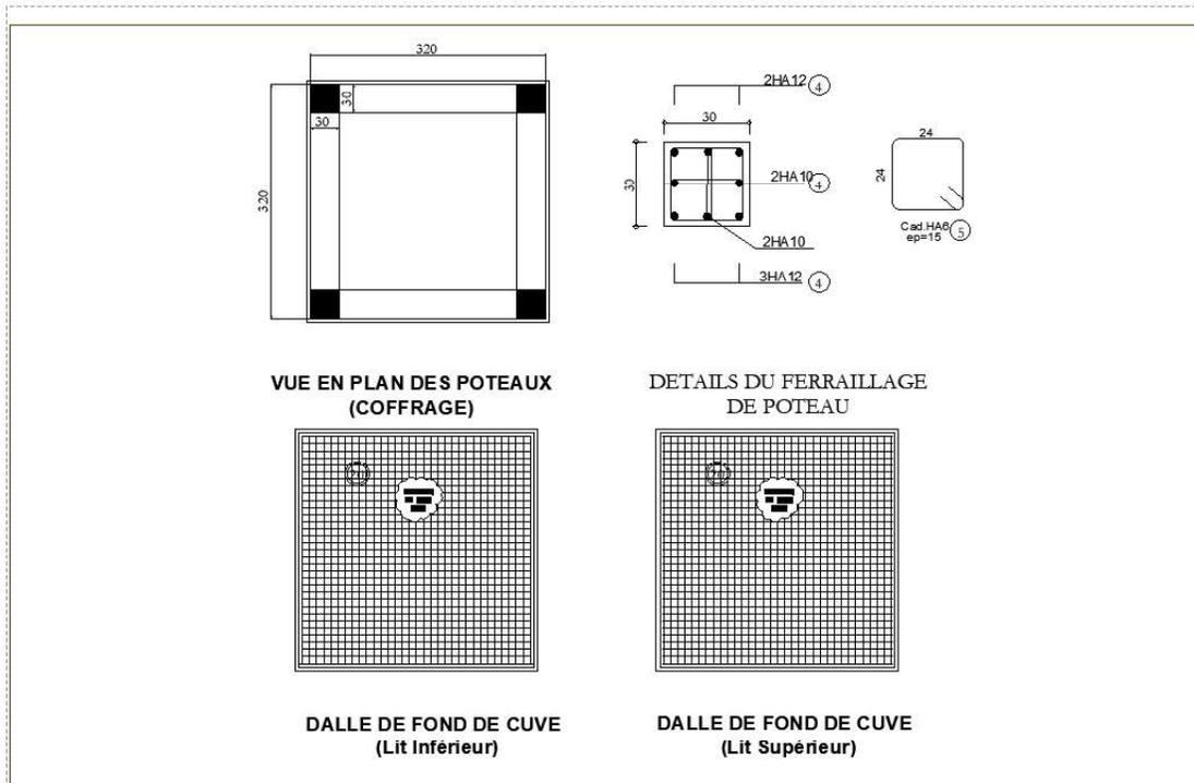
Fig1 : Plan type de château d'eau de 30 m3 surélevé de 6m (détails cuve et entretoise)
