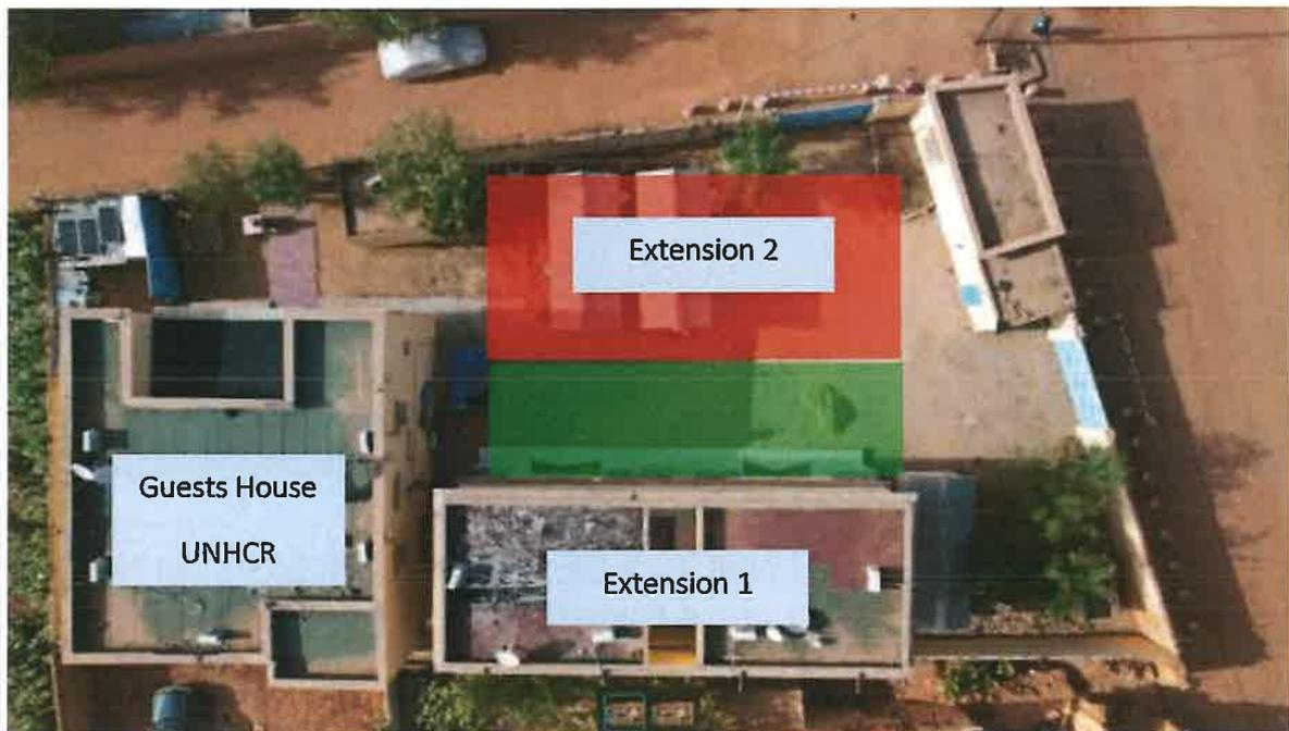
Le projet d'extension 2 de la Guest House implique la construction d'un bâtiment R+1 comprenant 8 chambres, chacune équipée de sa propre salle de bain. Sur les 8 chambres, 4 seront situées au niveau du rez-de-chaussée, tandis que les 4 autres seront situées au niveau du premier étage. Ce nouveau bâtiment sera conçu de manière symétrique par rapport au bâtiment existant de l'extension 1.
