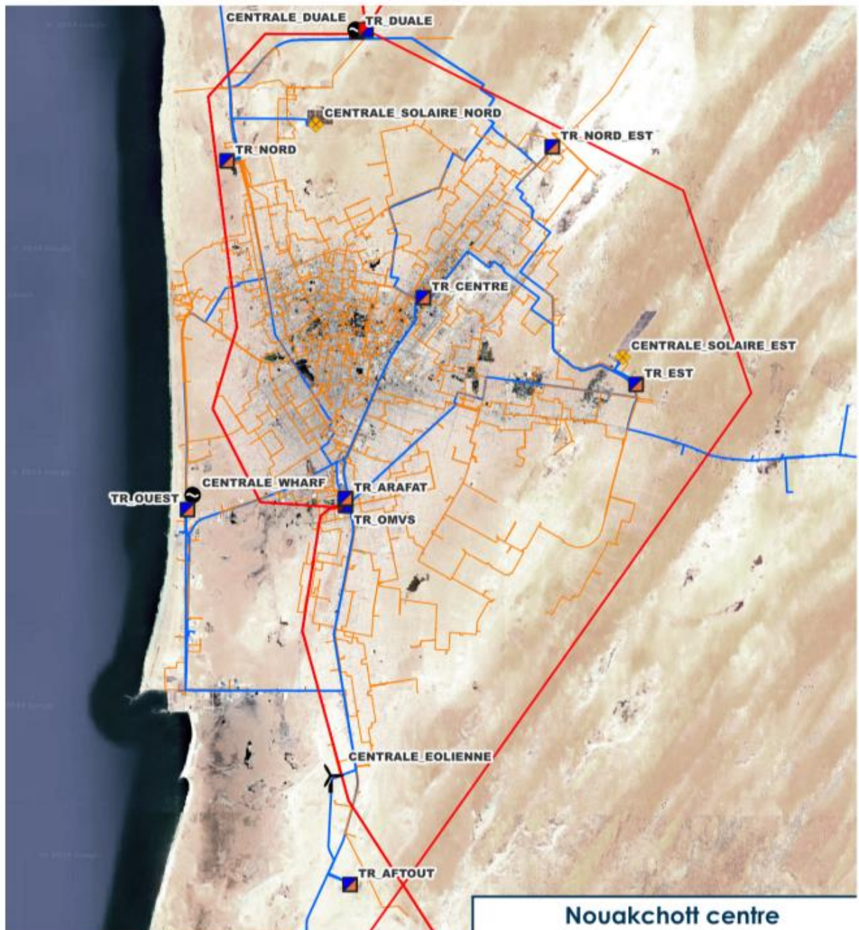
Figure 20 : Réseau 33 et 15 kV de Nouakchott et centrales de production
